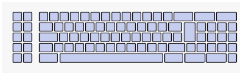
FIGURE 6.3 – Disposition des touches du clavier PC/XT
